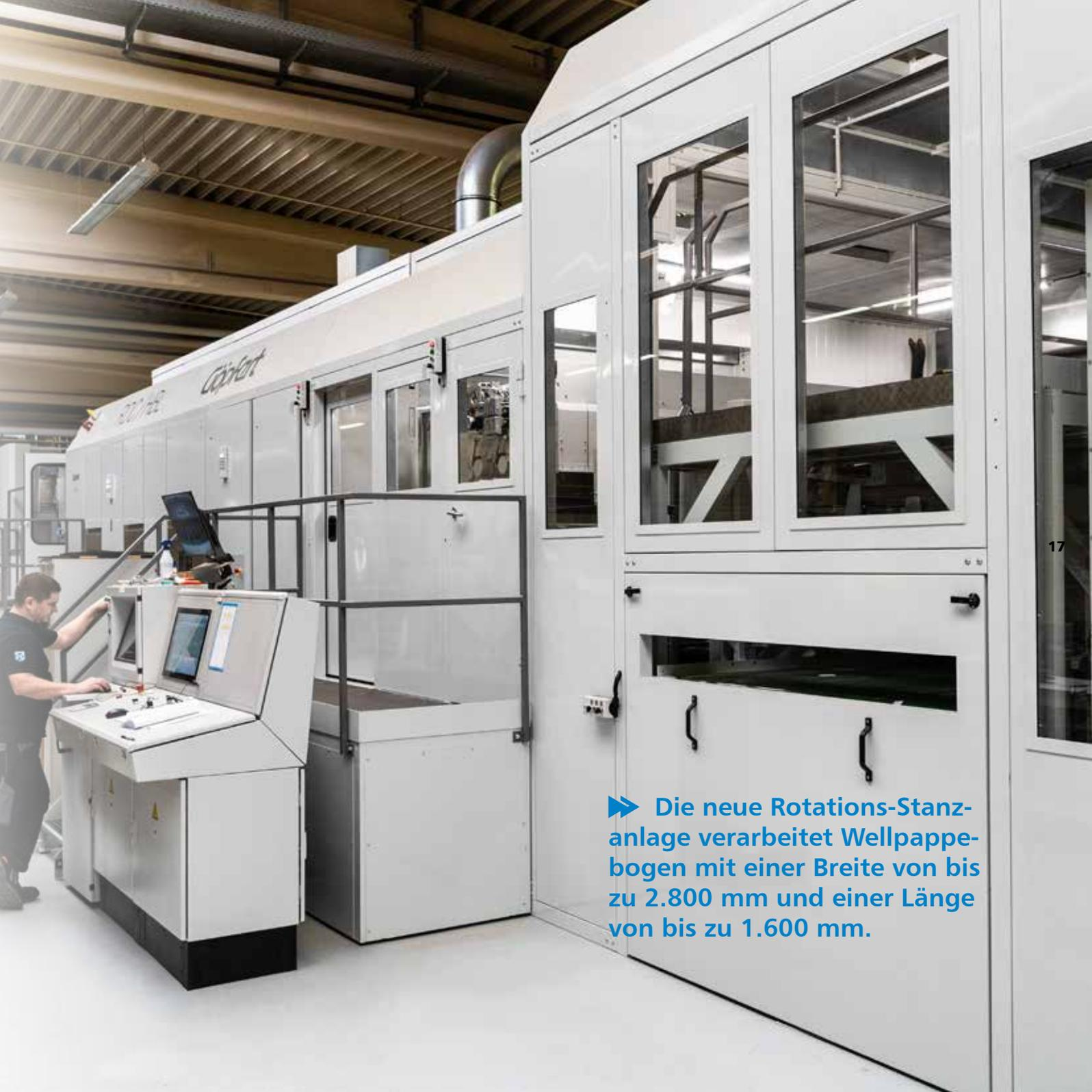
► Die neue Rotations-Stanzanlage verarbeitet Wellpappebogen mit einer Breite von bis zu 2.800 mm und einer Länge von bis zu 1.600 mm.
